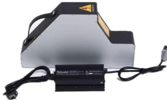
Die Retrokit-Vespa verfügt über einen austauschbaren Akku, der sowohl an Bord als auch unterwegs aufgeladen werden kann. Das leicht tragbare Ladegerät passt in das Fach unter dem Sitz, sodass Sie es immer bei sich haben und überall bequem aufladen können.
