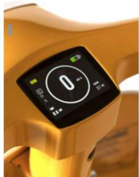
Das digitale Display der Retrokit Vespa fügt sich perfekt in das klassische Design ein und ist je nach Modell in drei Formen erhältlich: rund, oval und rechteckig. Es zeigt Geschwindigkeit, Akkustand, Reichweite, Leistung und Fahrmodus an. Mit der speziellen App können Sie alle Parameter überwachen, OTA-Updates durchführen und Fahreinstellungen direkt von Ihrem Smartphone aus anpassen.
